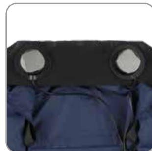
Dispositivo Peltier colocado en dos puntos en la base del cuello
